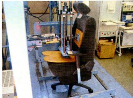
図6 座面および背もたれの耐久性試験
