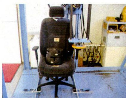
図 5 ひじ部の静的垂直力試験
